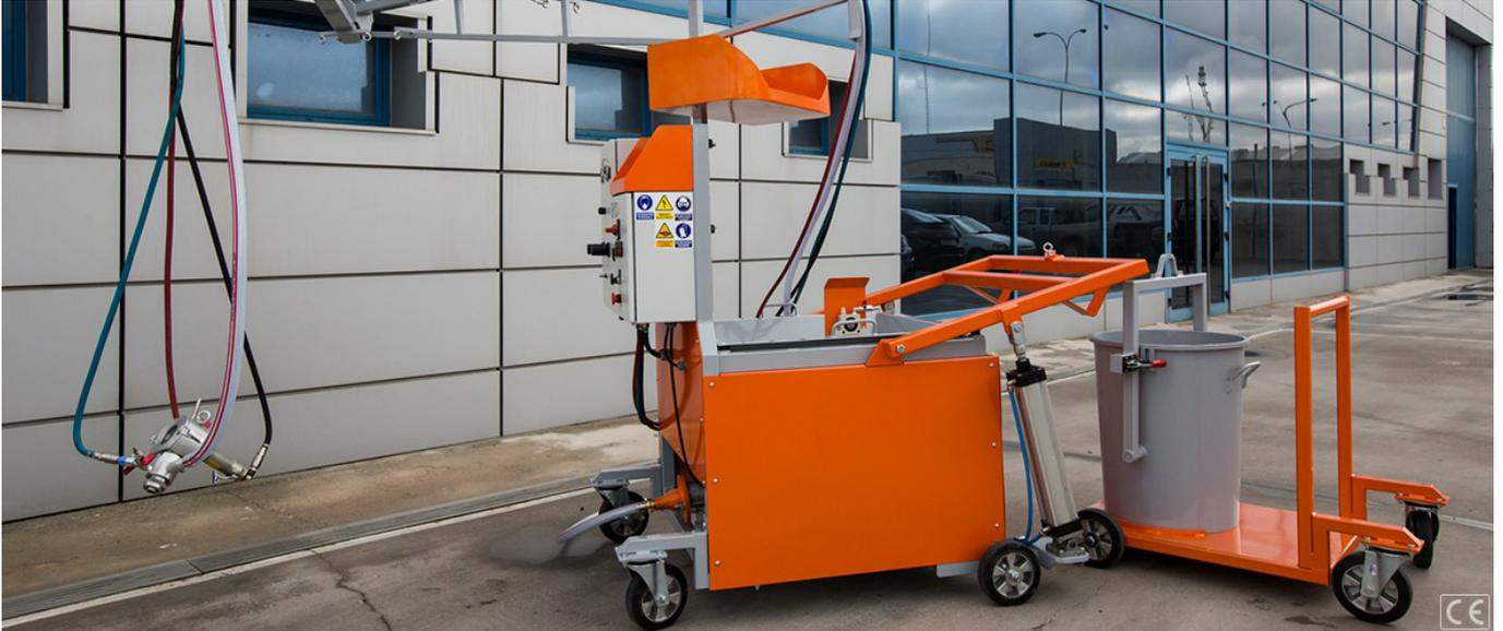
Máquina o Equipo de Trabajo: Proyectora de Mortero GRC
